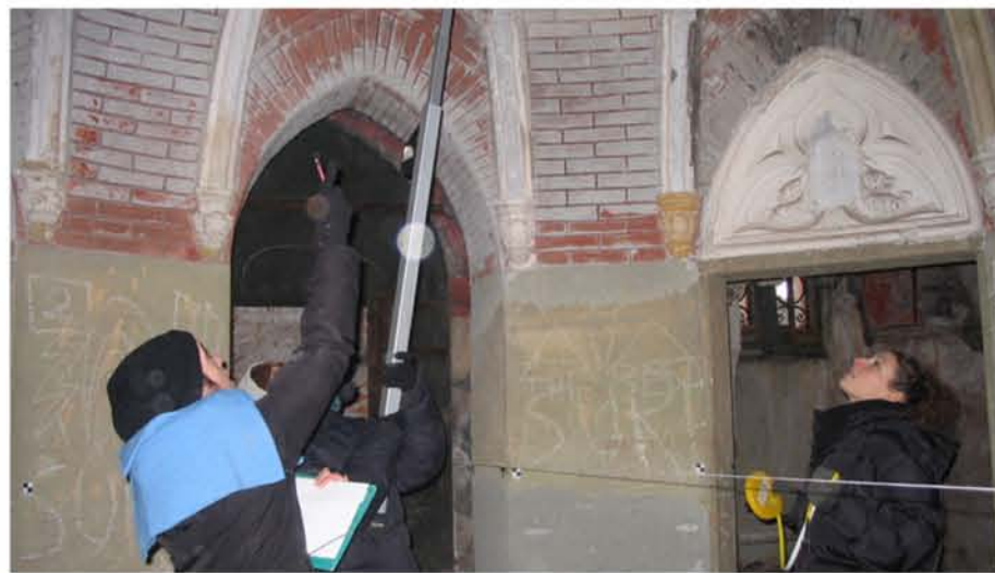
Stralcio Ambiente A9 Rilievo longimetrico Misurazioni parziali e di dettaglio volte alla restituzione dell'articolazione geometrica dell'ambiente e degli elementi architettonici che lo caratterizzano. Scala 1:20
