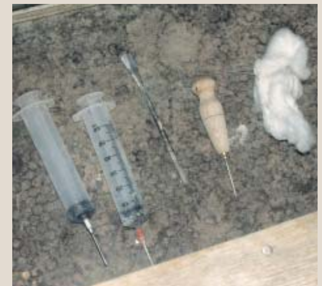
7. Strumenti necessari all'iniezione di materiale preconsolidante. Da sinistra a destra: 1) siringhe graduate con aghi di diverso diametro; 2) spatola di precisione; 3) punteruolo; 4) ovatta.
