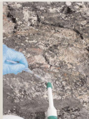
**4. Risciacquo della superficie con acqua e rimozione della biomassa ormai necrotizzata con l'azione meccanica di uno spazzolino.**
