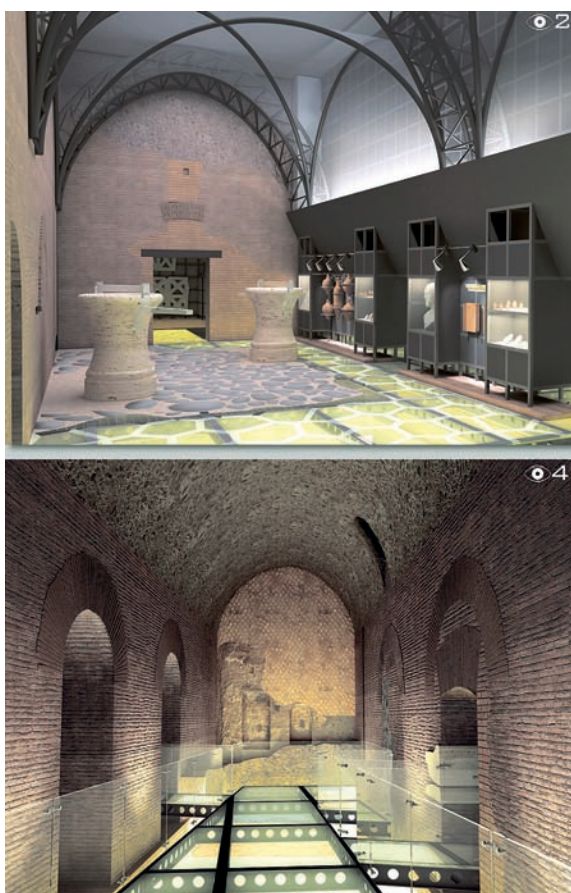
FIGURA 14 • Progetto di restauro e di allestimento dei sotterranei di S. Pudenziana a Roma (arch. Andrea Agamennone). In alto: veduta dell'ambiente del pistrinum , con la pavimentazione in basolato integrato in quota con la passerella in acciaio e vetro, la ricostituzione del profilo voltato tramite un sistema in metallo e telo che scherma il nuovo solaio coibentato superiormente, la disposizione delle vetrine a ricostituire l'originario diaframma spaziale e a celare le tubazioni dell'impianto di climatizzazione. In basso: veduta della passerella in un ambiente delle domus del II secolo.
