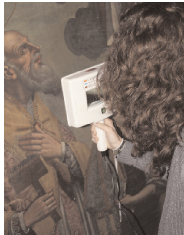
Un momento dell'analisi con lampada di Wood su uno dei dipinti su tela custoditi nell'Oratorio.
