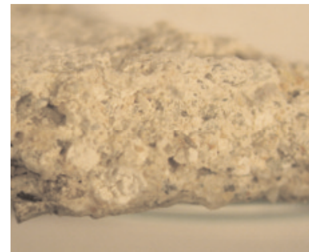
Micro-campione di malta da allettamento con legante di calce debolmente idraulica e aggregato di fiume, al microscopio ottico (10x).
