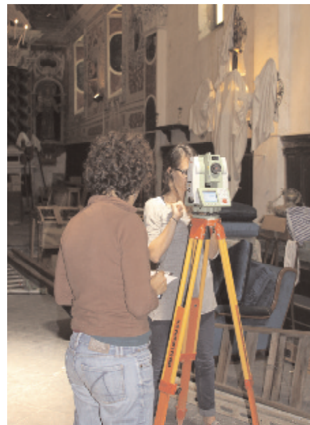
Un momento del rilievo topografico con la "stazione totale" Leica TS15.
