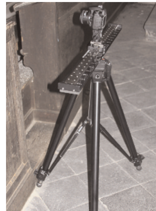
Fotocamera calibrata fissata su una slitta di precisione per l'acquisizione delle immagini utili al rilievo fotogrammetrico digitale tridimensionale.
