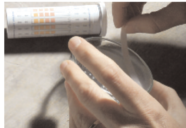
Test per rilevare la presenza di solfati: immersione della striscia nella soluzione salina.
