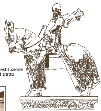
Statua equestre di Cangrande della Scala, Museo di Castelvecchio a Verona. Rilievo topografico e fotogrammetrico di precisione del monumento, con restituzione mediante griglia digitale di tutta la superficie scultorea, per la costituzione di un modello tridimensionale della statua ai fini del restauro e delle forme di controllo nel tempo.
