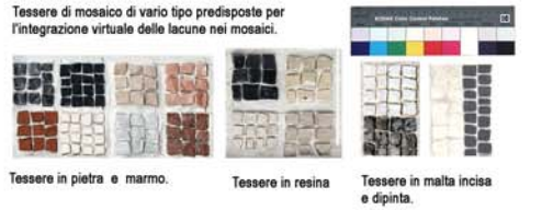
Tessere di mosaico di vario tipo predisposte per l'integrazione virtuale delle lacune nei mosaici. Tessere in pietra e marmo. Tessere in resina. Tessere in malta incisa e dipinta.
